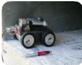
Robô no duto mockup em teste
